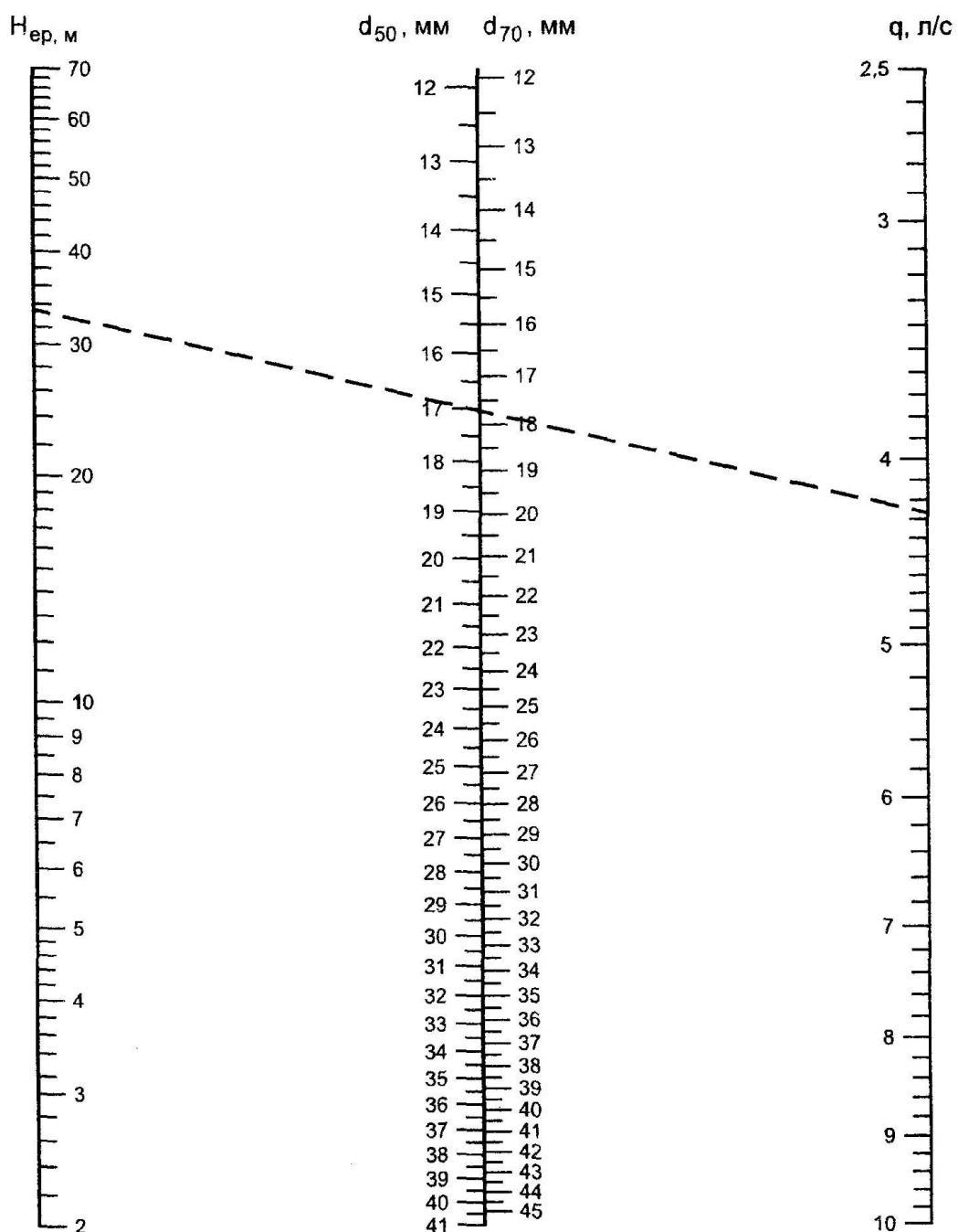
$d_{50}, d_{70}$  – диаметры отверстий диафрагм, устанавливаемых
